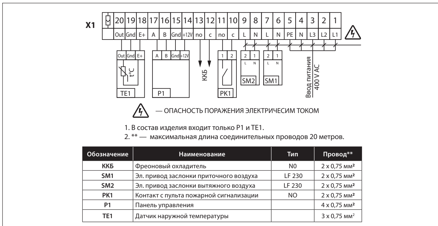
Рис. 11. Схема электрических подключений KOMFORT EC DE2000-12 ... EC DE4000-21
