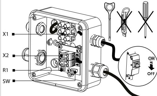
Подключите ответную часть клеммника X1 и X2 и соберите в обратном порядке.
