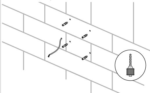
Установите вентилятор с помощью шурупов.
